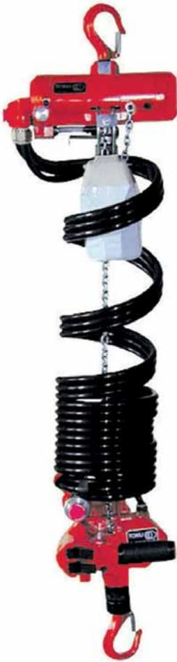
Der Kompaktkettenzug TCR-250ME mit einer Tragfähigkeit bis zu 250 kg eignet sich besonders für „Material Handling“. Wie bei den Druckluftseilzügen befindet sich auch bei diesem Gerät die Drucktastensteuerung am Unterhaken. Somit ist es dem Bediener möglich, die Last direkt zu kontrollieren und genau zu positionieren.
