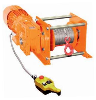
Für die Entwicklung der leichten und handlichen Elektroseilwinde P stand der Einsatz auf Baustellen sowie auf Montagen in Industrie und Handwerk im Fokus. Die Elektroseilwinde kann auf Grund ihrer konstruktiven Eigenschaften leicht an den Verbindungsstangen getragen werden. Die elektrische Seilwinde kann überall, wo ein festes planes Fundament gegeben ist, verschraubt werden, wobei die Einbaulage keine Rolle spielt. (Bitte bauseits für eine sichere Statik sorgen!)
